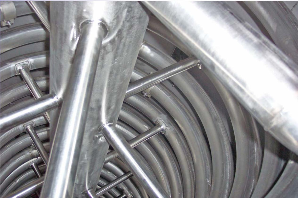
*Vista del serpentino di riscaldamento della macchina da 12000 kg*
